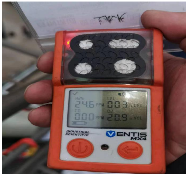
图 3 垫片破损处检测有毒气体数据
